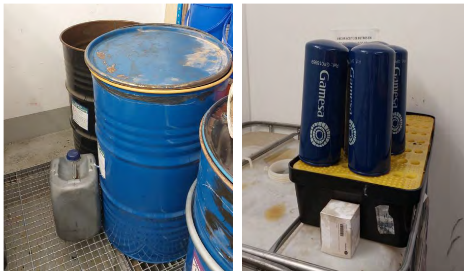
Fotografías 29 y 30: Contenedores de Residuos Peligrosos y cubetas de contención
